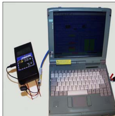
Messvorrichtung mit Inspector auf Philion-Platte und kompletter Steuerung (Messwerterfassung, Messwertspeicherung und Stromversorgung des Inspectors) über Notebook
