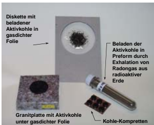
Radon aus Baustoffen und Erde
