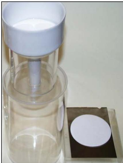
Abb. 9: Büchner-Trichter mit Glasfaserfilter
