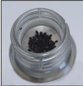
Abb. 8: Siebeinsatz mit körniger Aktivkohle in PET-Preform
